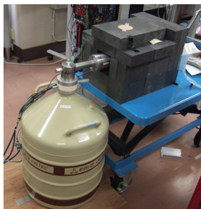
図1 本実験で使用したGe半導体検出器
