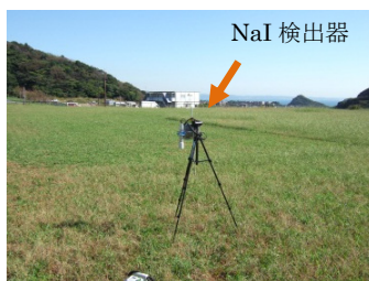
図 1 放射性セシウム沈着量測定の様子
