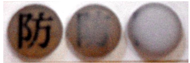
図 1 作成したアルミナ焼結体 (厚さ 1.7 \text{ mm} ) 左から昇温速度 5, 20, 50 \text{ K/min}
