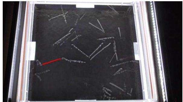
図 1 \alpha 線の飛跡と画像処理で検出された飛跡の輪郭（赤線）
