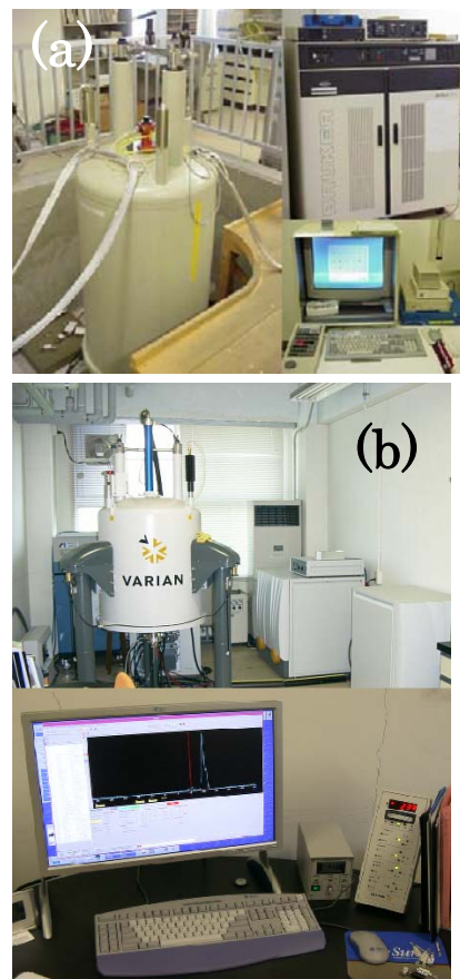
図 4. (a) ブルカー社製 DMX500 NMR 装置と (b) バリアン社製 400WB NMR 装置。
