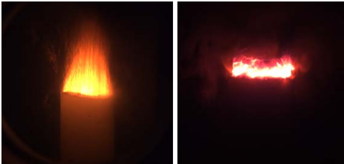
図2 高速度カメラで撮影した推進薬の燃焼状況
