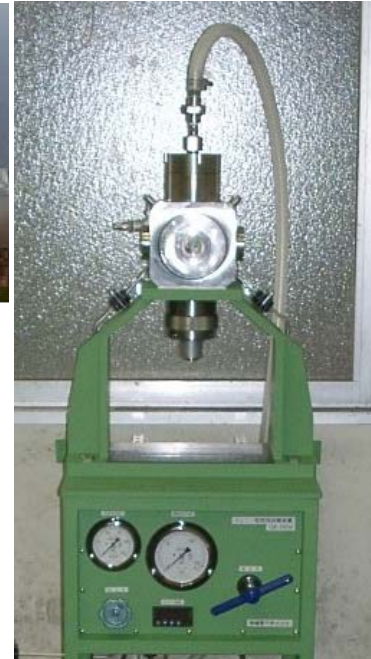
図1 燃焼試験装置
