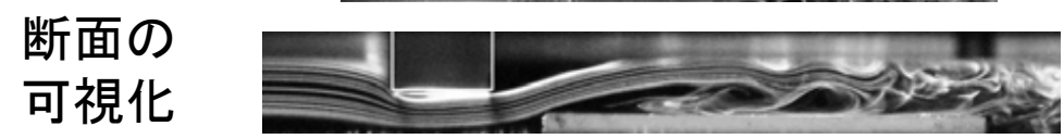
2D 障害物設置 ( u_m = 0.78 m/s, 障害物高さ 5.4 mm)
