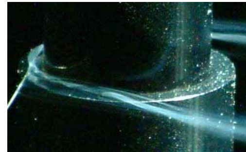
段差位置で形成される渦 u_0 = 8 \text{ m/s}, \text{Re} = 10000
