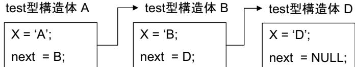
3つの構造体が上のようにつながっているとします。構造体BとDの間に構造体Cを入れるには、下図のようになります。
