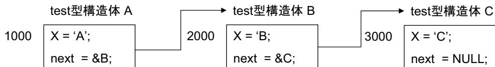
問39 test型構造体A,B,Cを作成し、上の図のような状態にせよ。変数Aのみを用いて、ABCと出力してみよ。
